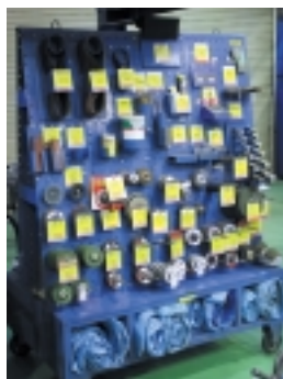
「定位置」「定量」「定方向」「表示」「標識」を徹底した3S活動を象徴するひとつ。ムダなストックが全くない
